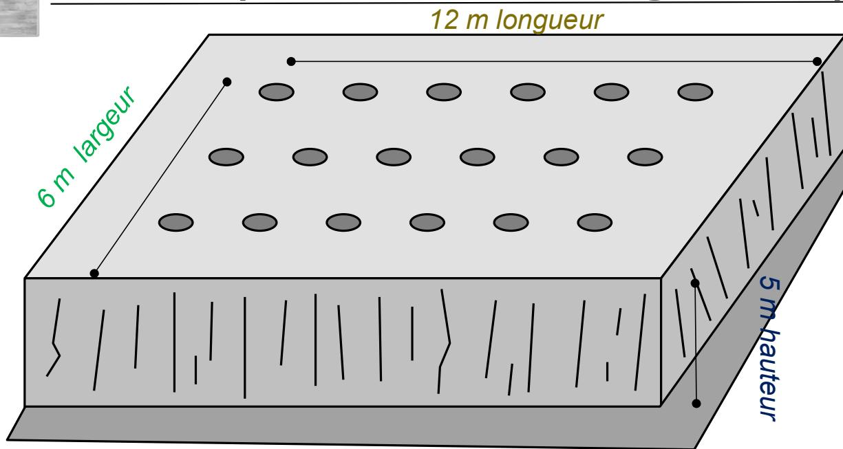
Explosifs par trou  $10 \text{ kg} \times 18 \text{ trous} = 180 \text{ kg total}$
