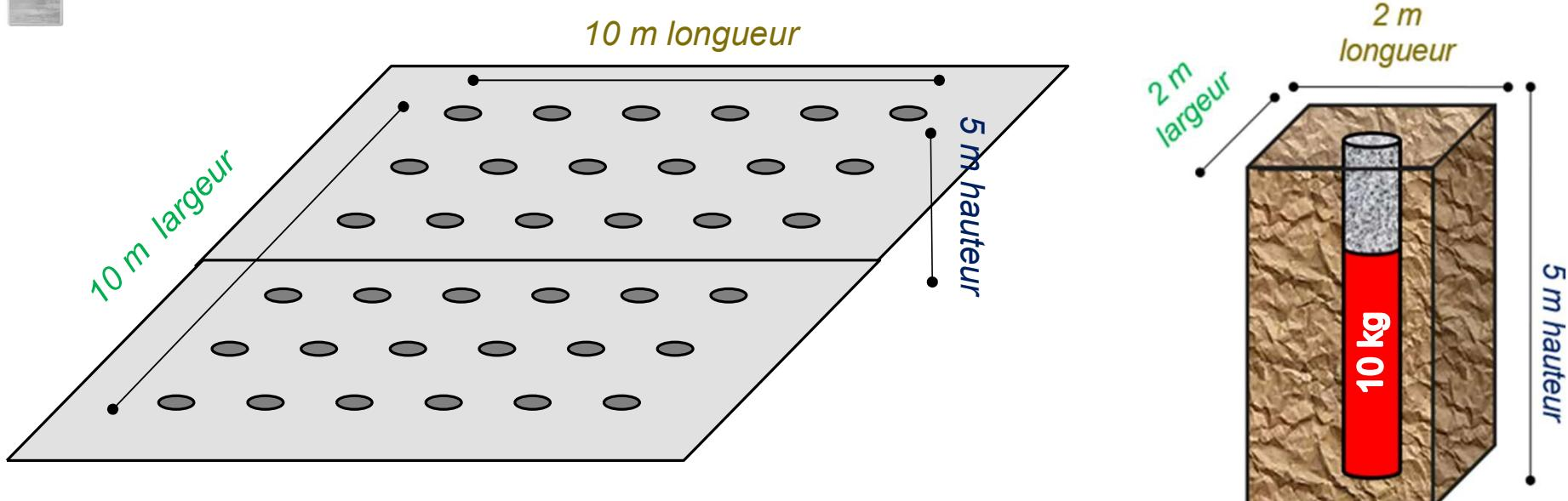
Explosifs par trou  $10 \text{ kg} \times 36 \text{ trous} = 360 \text{ kg total}$
