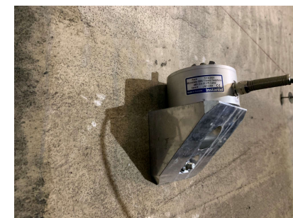
Géophone standard ancré au mur avec base aluminium
