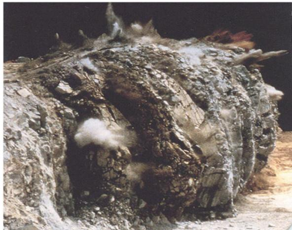
La vitesse de réaction crée une onde de choc qui brise la roche
