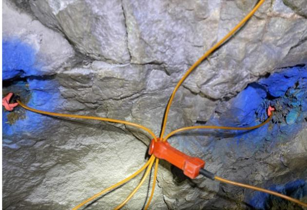
Amorçage avec Détonateurs Nonel vs Cordeau détonant
