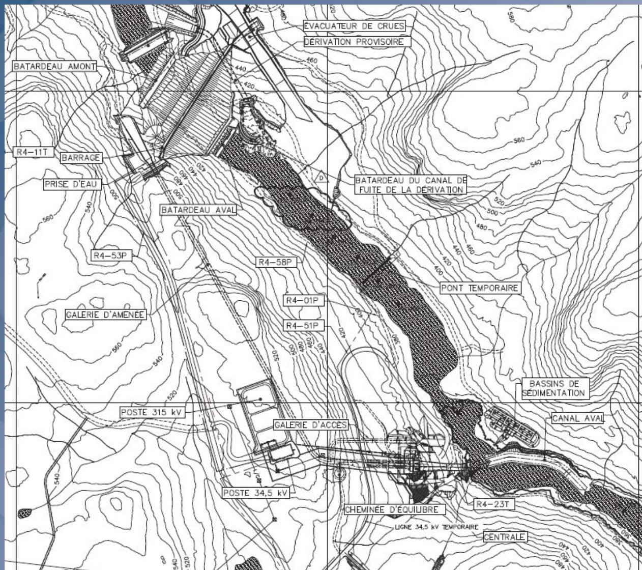
Hydro-Québec, Plans projet Romaine-4 - Excavation du bouchon du canal de fuite de la centrale
