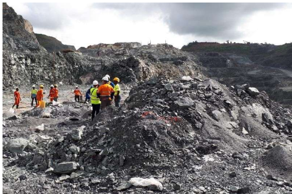
Figure 3 : pieds restants, conséquence de fardeaux en pied trop importantes
