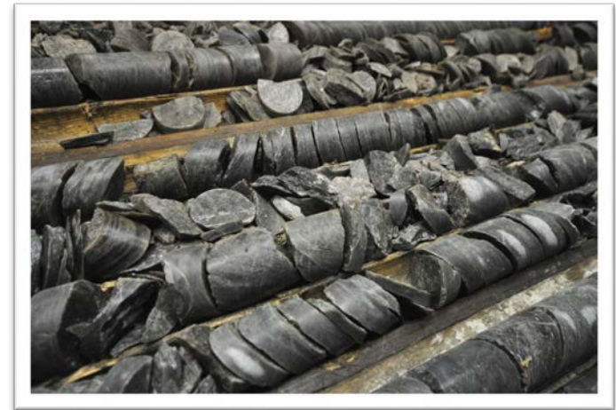
Figure 11 : Carottes de forages hautement fracturées (tiré de Giroux, 2016)
