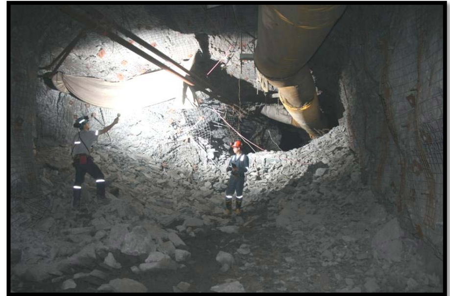
Figure 10 : Coup de terrain à la mine LaRonde (tiré de Giroux, 2016)
