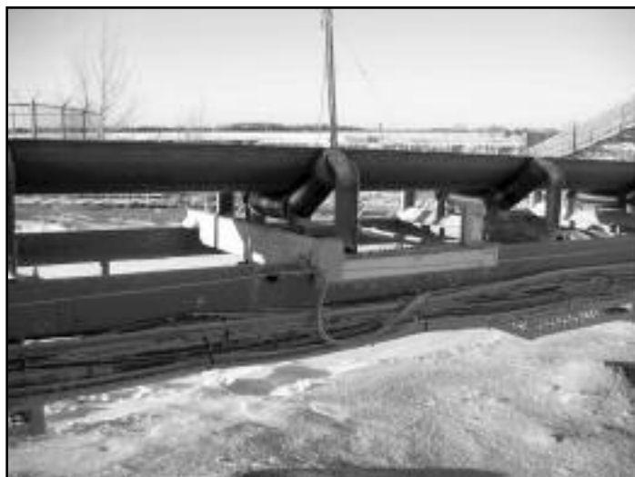
Figure 4 : Balance à courroie typique montée sur un convoyeur
