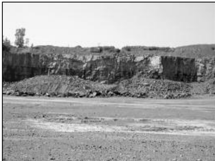
Sautage 1: Patron de 3,65 m x 4,25 m / Sautage 2: Patrons de 3,65 m x 4,25 m & 3,95 m x 4,25 m
