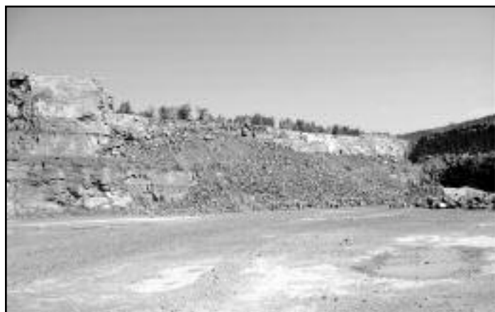
Sautage 3: Patron de 3,35 m x 3,95 m avec un diamètre de forage de 115 mm
