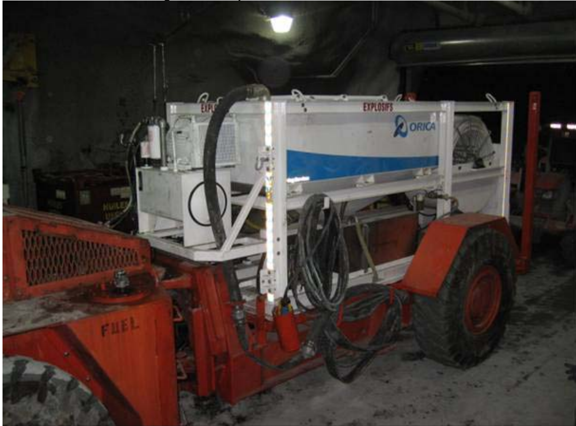
Figure 5: Pompe Orica montée sur un camion
