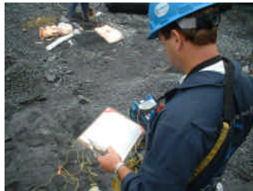
Programmation des détonateurs électroniques IKON
