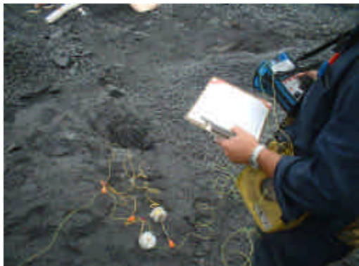
Programmation des détonateurs électroniques IKON
