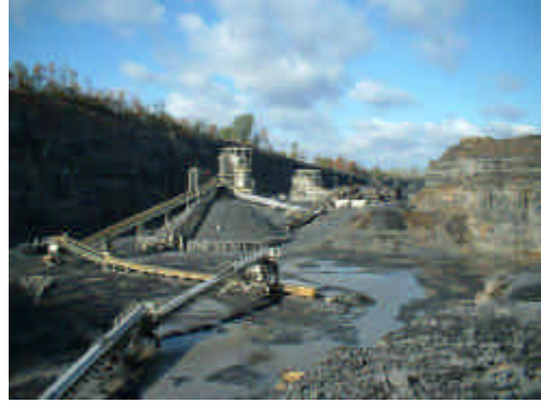
Concassage primaire avec locotrac LT-140 et usines secondaire et tertiaire.
