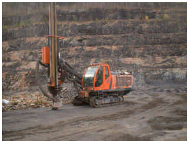
Foreuse avec marteau en fond de trou (DTH)
