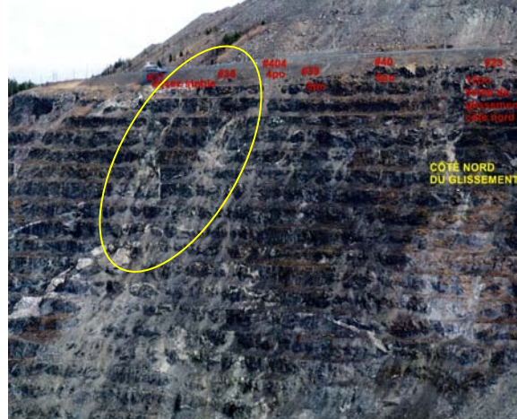
Photo 8: Rupture en dièdre en formation qui se répercute sur la chaussée abandonnée (photo 9).
