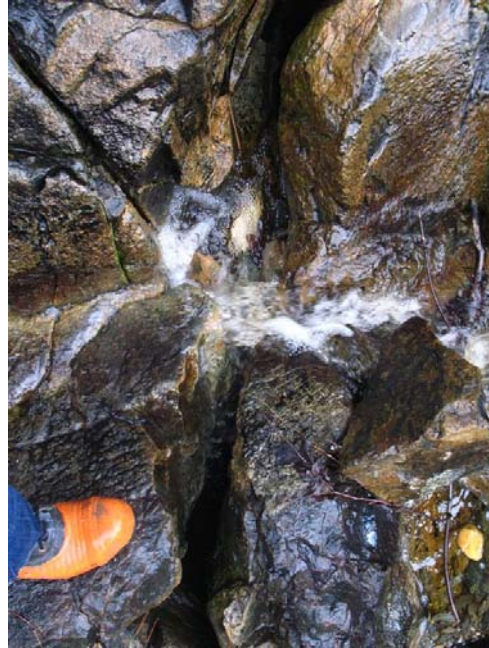
Photo 18: Toute l'eau s'engouffre dans une série de fractures ouvertes lesquelles, à date, correspondent à la crête du glissement.
