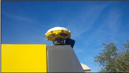
Foreuse équipée de GNSS (GPS)
