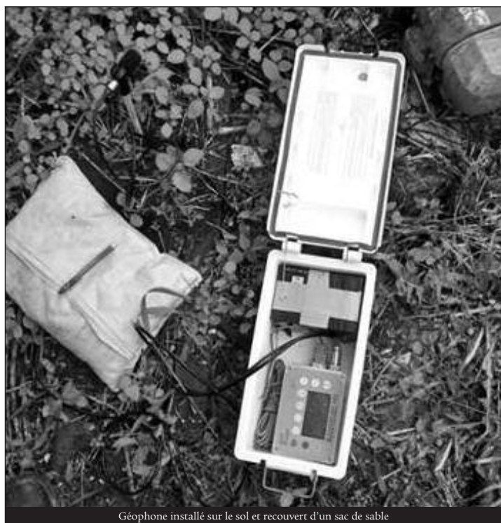
Géophone installé sur le sol et recouvert d'un sac de sable
