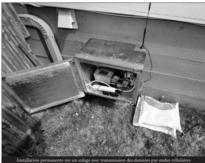
Installation permanente sur un solage avec transmission des données par ondes cellulaires
