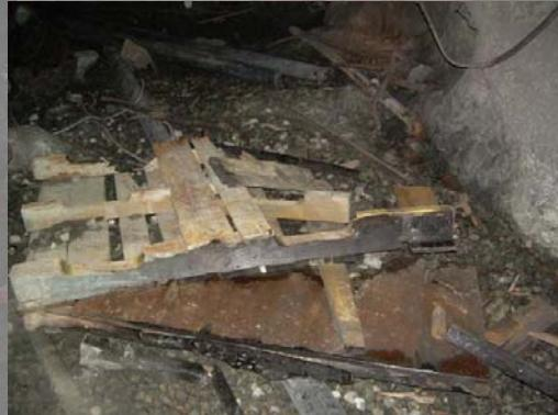
Explosion lors de forage pour le fonçage d'un puits de mine. Des explosifs étaient présents dans un fond de trou. (2006)
