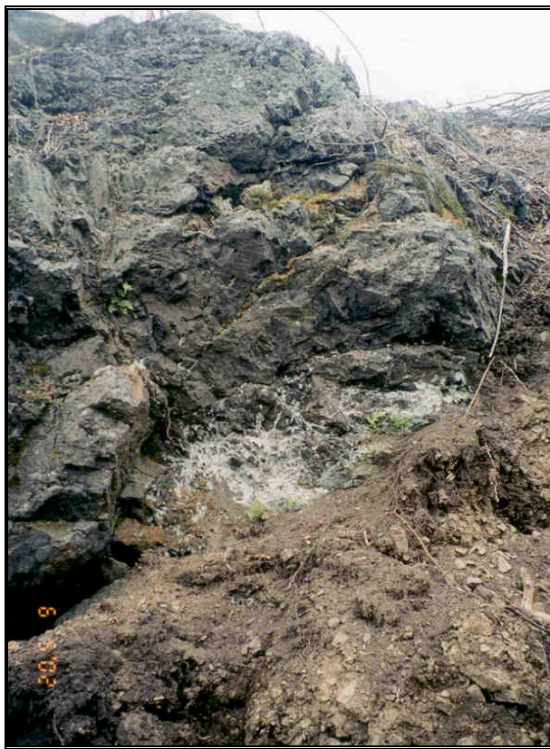
Photos 2 et 3: Affleurements visibles sur le terrain lors de l'étude géologique. On remarque la forte densité de fracturation du roc.
