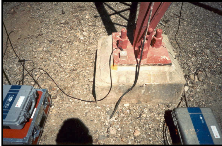
PHOTO 17 – PATTE AVANT DE LA TOUR, AVEC GÉOPHONE ET SISMOGRAPHE
