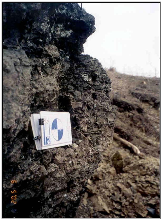
Photos 2 et 3: Affleurements visibles sur le terrain lors de l'étude géologique. On remarque la forte densité de fracturation du roc.
