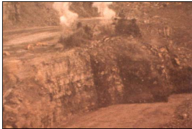
Photo 14: Par l'excavation du front d'abattage on obtient un meilleur déplacement et par conséquent une meilleure fragmentation du roc.
