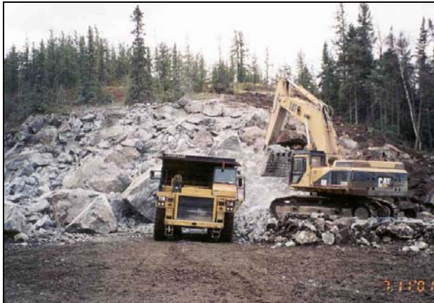
Photo 12: Blocs surdimensionnés après sautage
