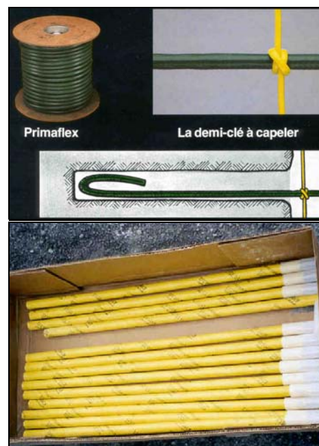
Figure 6: Évolution du chargement des trous de prédécoupage. Avec le temps, les fournisseurs ont développé des explosifs spécialement conçus pour le prédécoupage, soit sous forme de cordeau détonant ou encore sous forme d'explosifs en bâton que l'on peut rabouter. Il existe également aujourd'hui des émulsions explosives sous formes de boudins qui peuvent être utilisés pour le prédécoupage, notamment pour les trous à grand diamètre.
